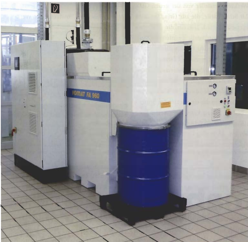
Vomat Filtrationsanlagen sind ideal zur Filtration von Feinstpartikeln aus Schleifölen.
